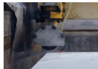
Proceso de corte con aporte de agua en sistema abierto (Fuente: Cosentino TV)
